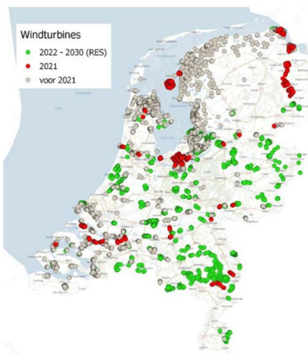
Figura 4: Ubicazione di tutte le turbine eoliche nei Paesi Bassi entro il 2030, differenziate per data di installazione. (Dati cartografici dalla registrazione della topografia di base (BRT)).
